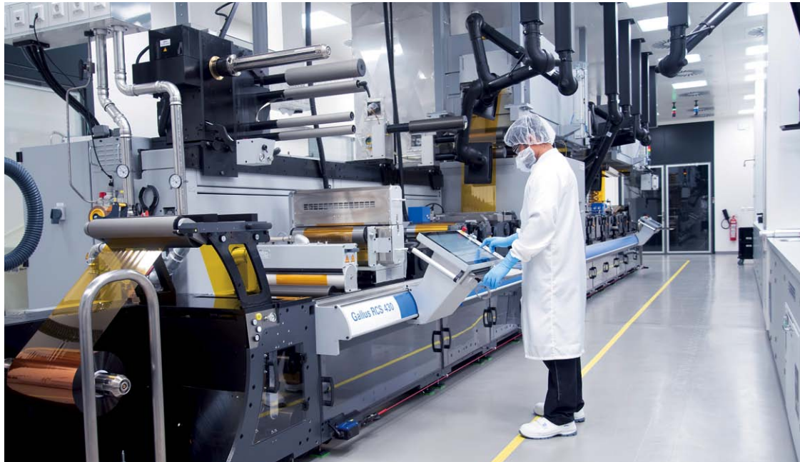
Neue Stückzahlendimension: Diese Druckmaschine kann pro Stunde einen Tennisplatz voller Sensoren produzieren.
